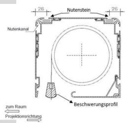
Einbausituation: Projektionstuch vorn ablaufend bei Aufprojektion
